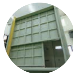
風雨試驗設備
